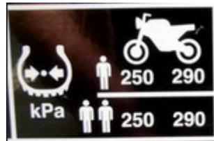
Le sur-gonflage accélère l'usure du pneumatique et défavorise la tenue de route sur chaussée détrempée. Le pneu rippe.
